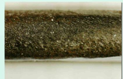
stark deformierte Oberfläche nach dem Bürsten
